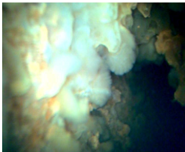
Obr. 5: Povlaky tvořené mikroorganismy a jejich mezibuněčnými polysacharidy (vrt K1 Drhleny).
